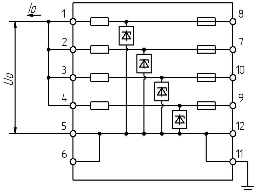
Рисунок 27 – Любые четыре плача параллельно относительно земли
