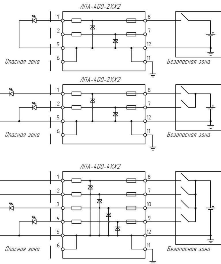
**Рисунок 9 – Типовые схемы питания устройств с заземленным источником питания**
