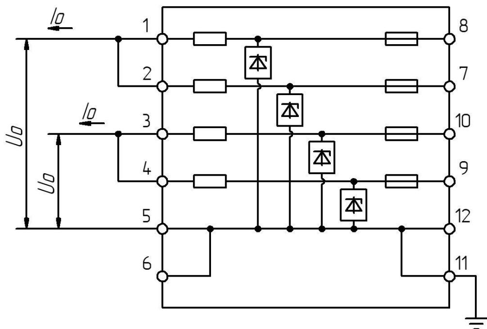
Рисунок 25 – Любые два плеча параллельно относительно земли
