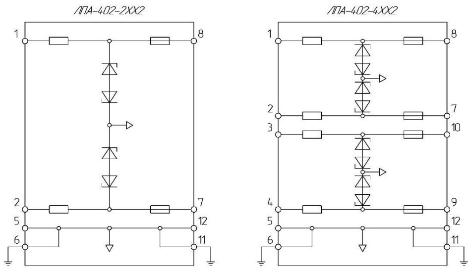
Рисунок 35 - Структурная схема барьеров ЛПА-402 для работы с сигналами переменной полярности
