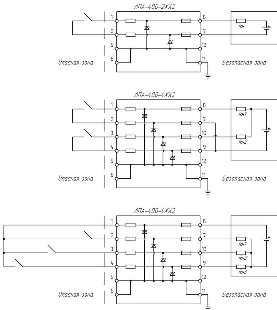
Рисунок 8 – Типовые схемы подключения пассивных дискретных датчиков с изолированным источником питания
