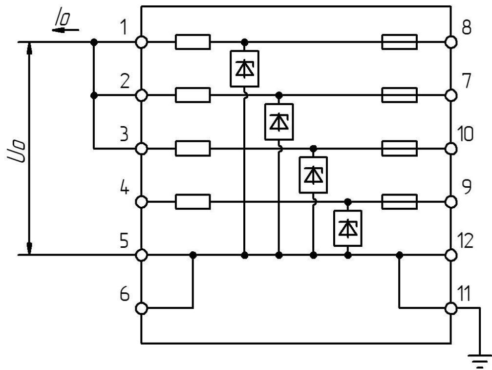
Рисунок 26 – Любые три плача параллельно относительно земли
