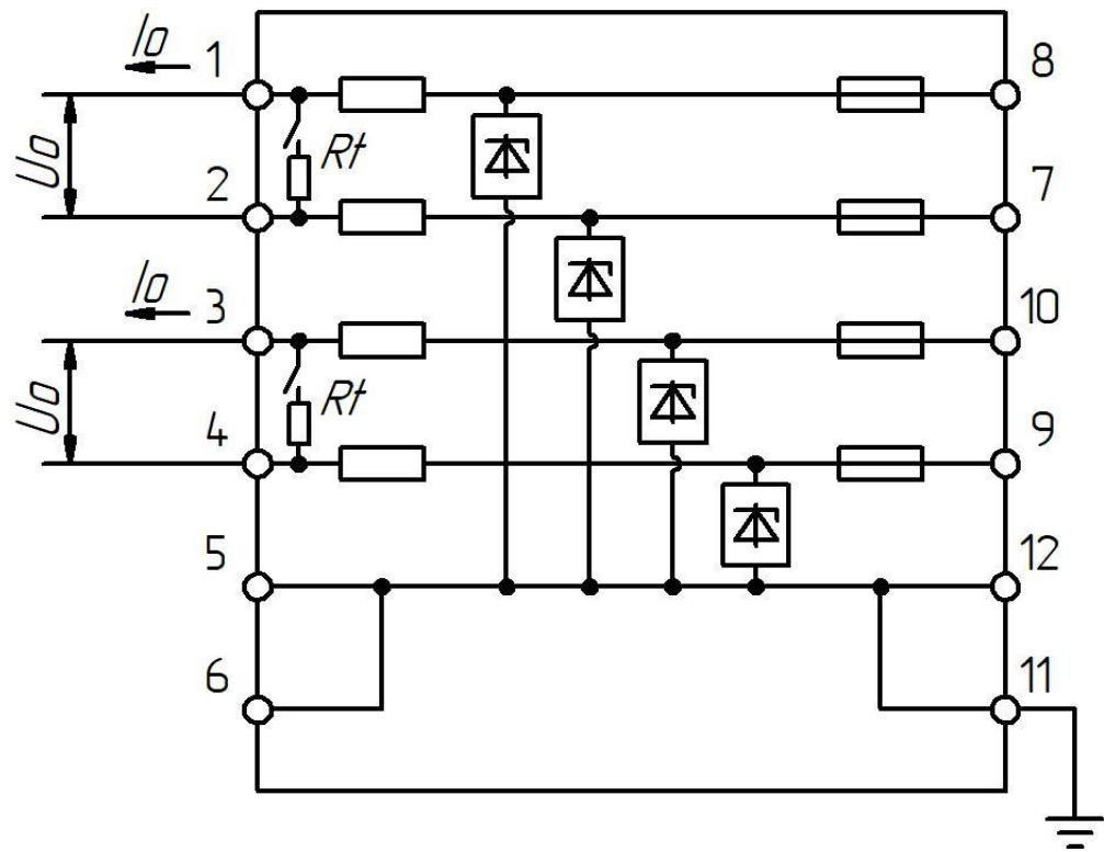
Рисунок 32 – (1 и 2) или (3 и 4) плеча последовательно (ЛПА-410)
