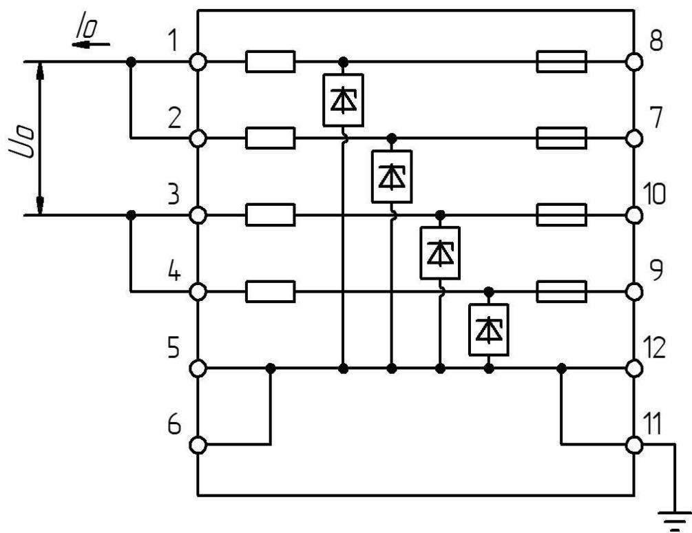
Рисунок 30 – Любые четыре плача последовательно-параллельно (2+2)
