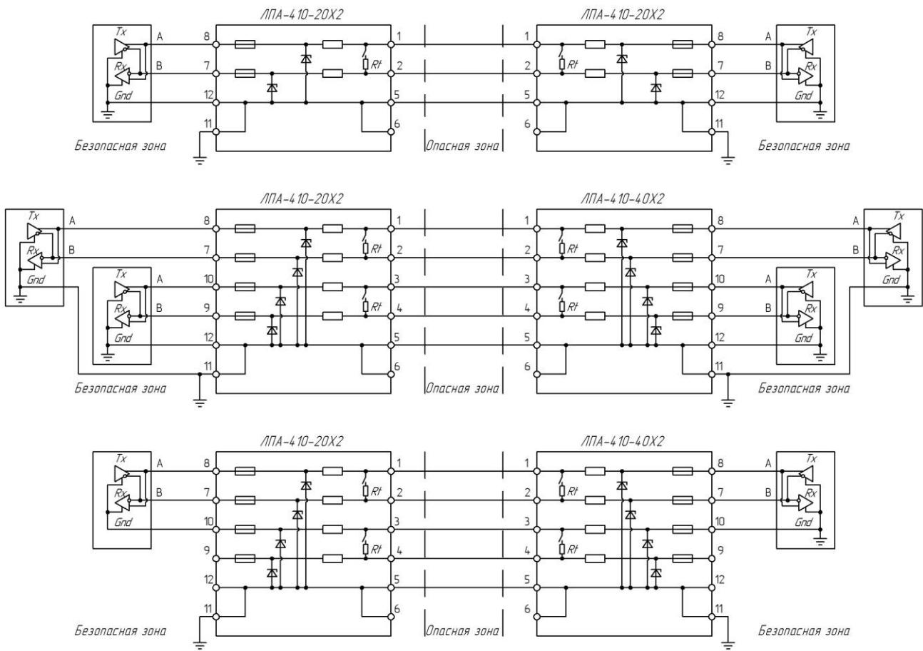
**Рисунок 16 – Типовые схемы подключения интерфейса RS-485 с транзистором сигнала через опасную зону**
