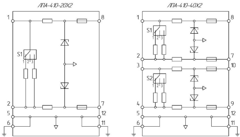
Рисунок 36 - Структурная схема барьеров ЛПА-410 для работы с сигналами интерфейсов RS-485 и RS-422
