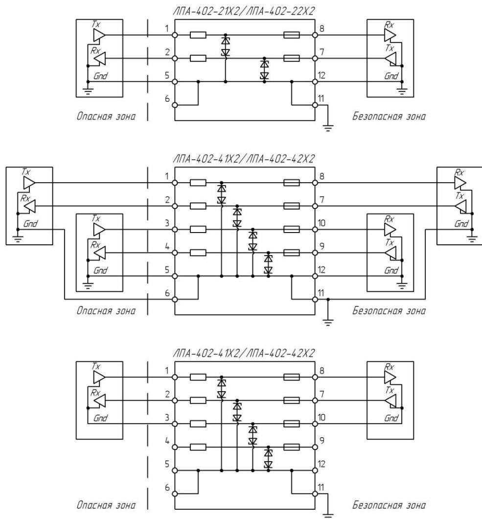
Рисунок 13 – Типовые схемы подключения интерфейса RS-232 с устройством в опасной зоне
