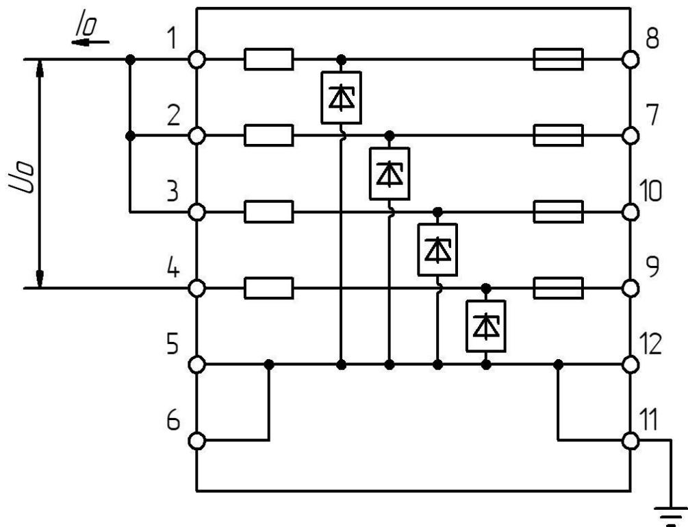
Рисунок 31 – Любые четыре плача последовательно-параллельно (1+3)
