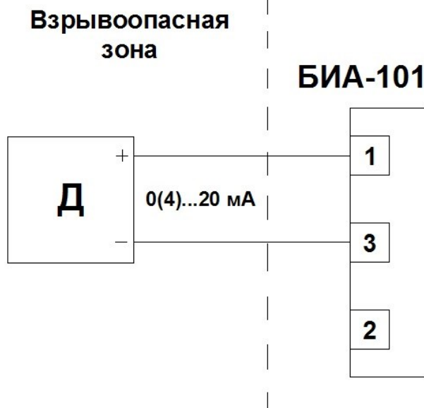
Рис.3. Подключение датчика с выходом 0(4)...20 мА по двухпроводной схеме
